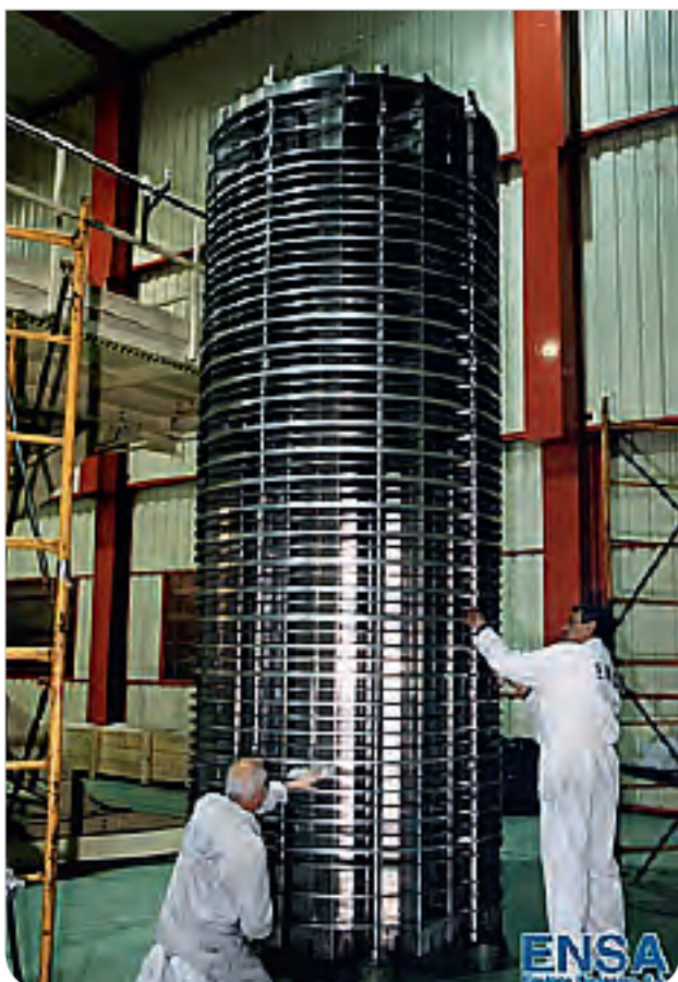
Ilustración 1. Internos del contenedor ENSA-DPT: discos de refrigeración y bastidor
